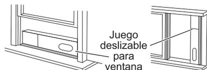
4. Corte la junta de espuma B (no adhesiva) de acuerdo con el ancho de la ventana. Introduzca la junta de espuma B entre el vidrio y la ventana para evitar que entren en la habitación aire e insectos.
