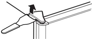
B. Remueva los dos tornillos de cabeza hexagonal de 5/16" ó 1/8", entonces levante la bisagra hacia arriba para liberarla del pasador de la bisagra.
