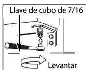
1. Usando una llave de 7/16, gire el tornillo de ajuste de la puerta hacia la derecha para elevar la puerta; gírela hacia la izquierda para hacerla descender. (Un tapón de nylon está encajado en la rosca del pin para impedir que el pin gire a menos de que se use una llave.)
