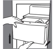
**Para devolver:** Al devolver la gaveta, asegúrese de presionarla firmemente en su sitio. Si no llega hasta el final, vuelva a sacarla y gire el mecanismo de manejo  $1/4$  de vuelta. Luego empuje de nuevo el entrepaño.
