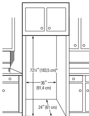
\*Se requieren 72 1/4" (183.5 cm) para un ajuste completo de las ruedas de movilidad. Si los gabinetes instalados por encima del refrigerador tienen puertas niveladas con la parte superior de la abertura para el refrigerador, entonces se requieren 1/8" adicionales para permitir espacio para que las puertas del gabinete se abran libremente.
