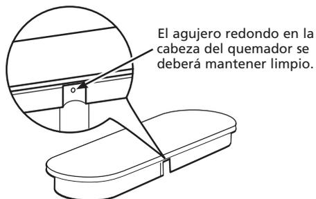
Para un encendido adecuado, asegúrese de que el agujero pequeño en la sección que coincide con el electrodo se mantenga abierto. Puede usar una aguja de coser o un precinto para desbloquearlo.
