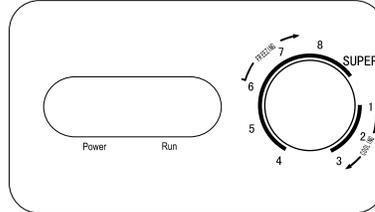
1. Conecte el congelador al suministro de energía. El indicador ENCENDIDO (POWER) de color verde, se enciende. El indicador OPERACIÓN (RUN) de color rojo, se enciende durante la operación del aparato.
